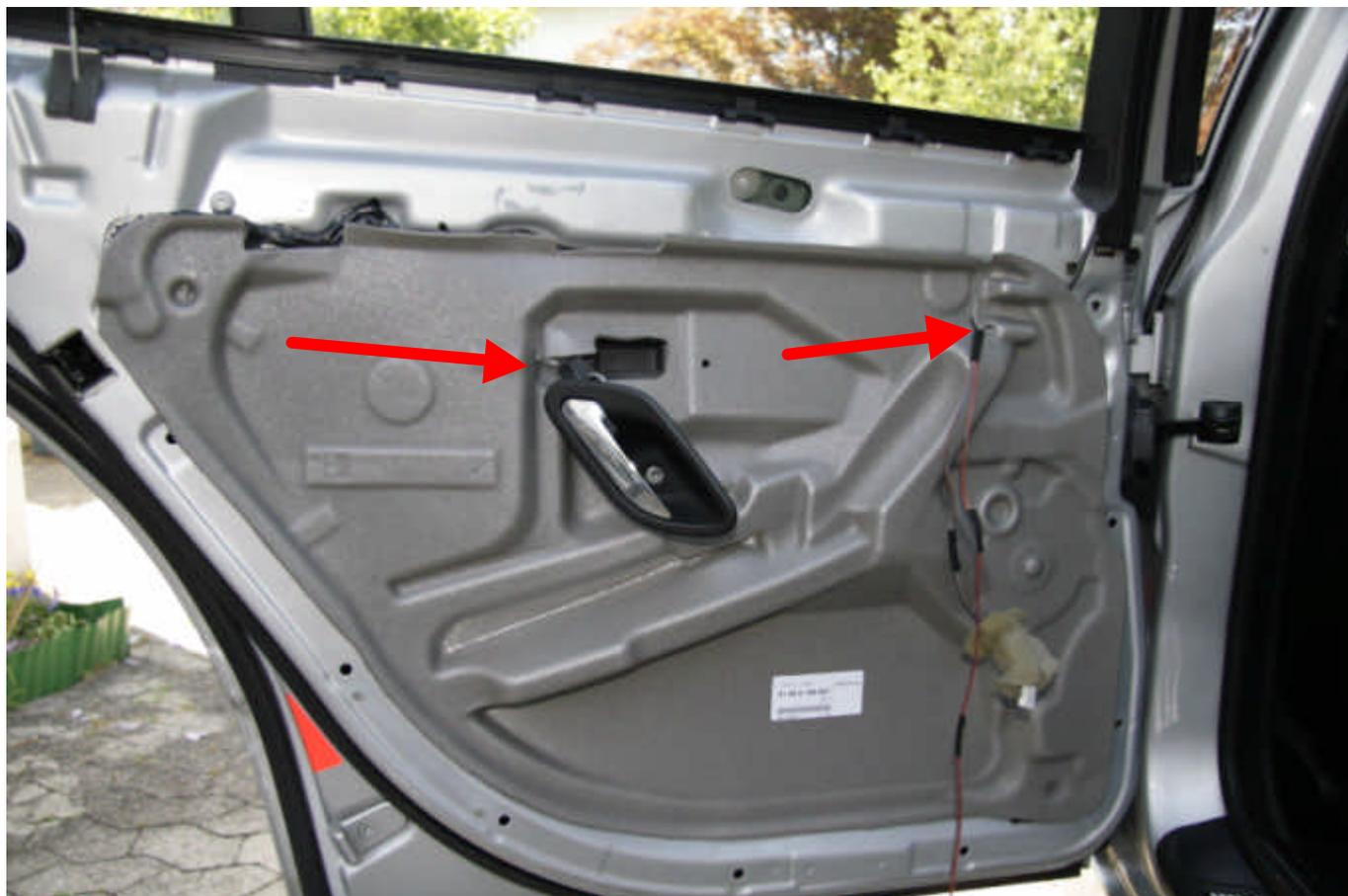
Im Anschluss noch die Türverkleidung eindrücken, die Kabel anschließen, Beleuchtung einsetzen, Türgriff anschrauben,...
