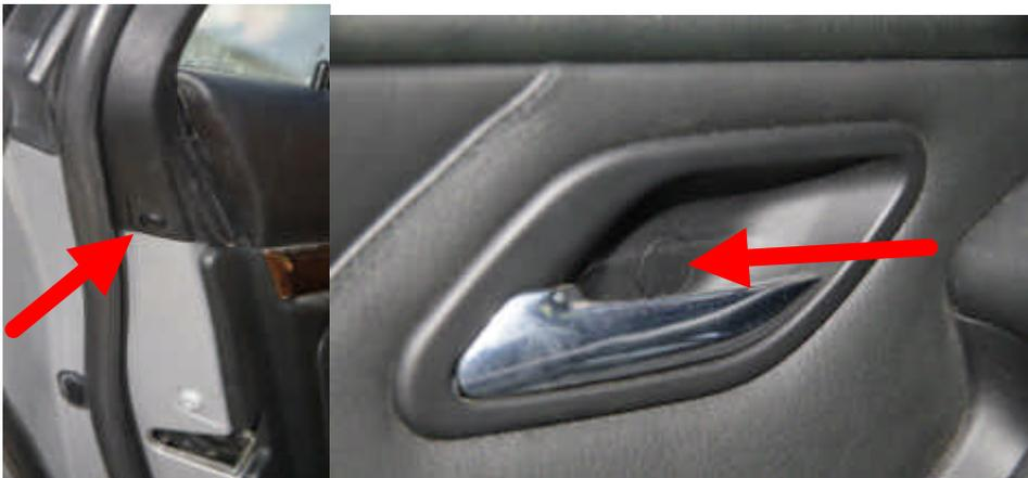
So bald die Torx-Schraube raus ist, muss noch der Fensterheber raus. Den Schalter mit dem Schlitzschraubendreher raushebeln.
