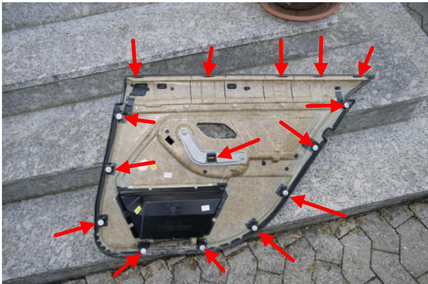
Den Türgriff durch die Öffnung schieben und das Kabel für den Fensterheber rausnehmen. Auf der Unterseite muss dann noch die Bodenbeleuchtung raus. Ich hab sie nicht abgesteckt sonder das ganze Teil einfach durch die Öffnung geschoben.
