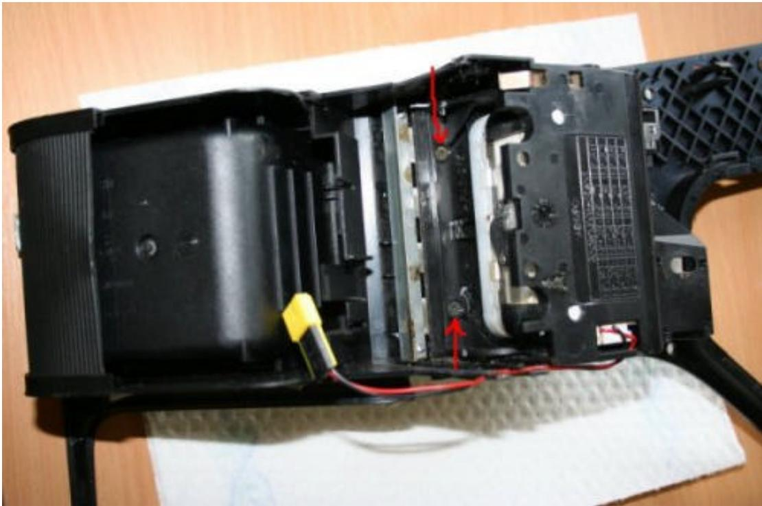
**Den Halter für den ZV und Warnblinkschalter kann man leicht nach unten herausdrücken.**
