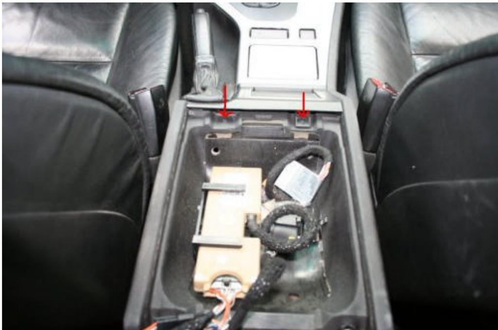
Danach vorne bei der Schaltung die 2 Schrauben lösen.
