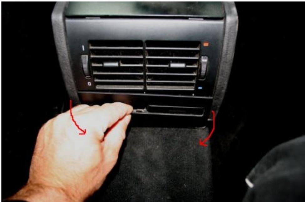
Dann die Lüftungsblende nach unten ziehen und die 2 Schrauben lösen.
