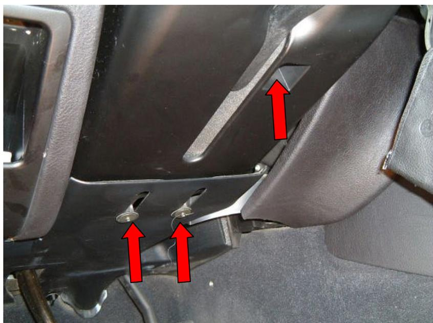
Obere Lenksäulenverkleidung auf beiden Seiten im gezeigten Bereich nach innen drücken und untere Verkleidung nach unten ziehen.
