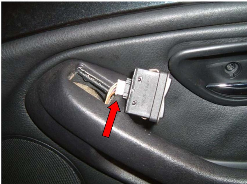
**Nun die Verkleidung seitlich und unter ausklipsen und nach oben schieben. Dadurch wird die Verkleidung aus dem mittleren clip ausgehaengt.**
