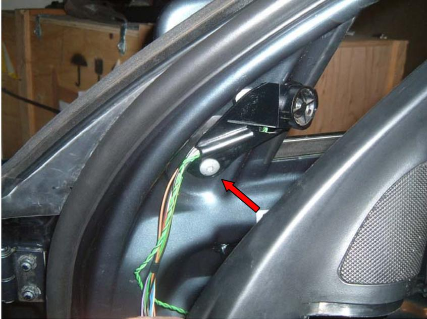
**Der Einbau erfolgt in umgekehrter Reihenfolge. Es ist darauf zu achten, dass der Clip in der Mitte auf der Verkleidung ist und nicht auf der Tuer.**
