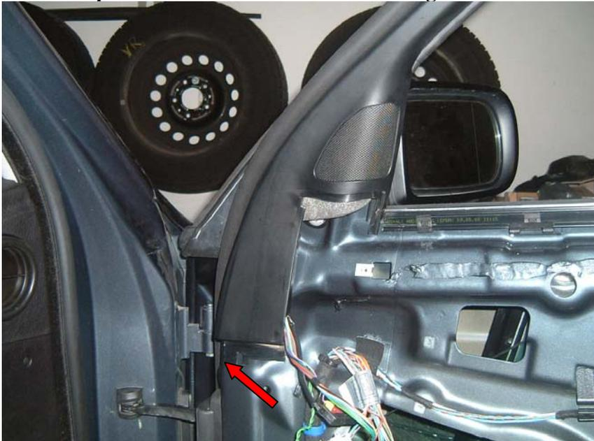
Den Schaumstoff entfernen und die untere Schraube fuer den Aussenspiegel loesen.
