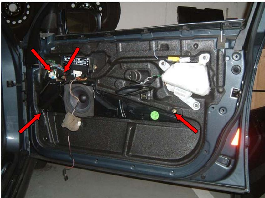
Um den Hochtoener zu demontieren muss die Fensterinnenverkleidung (Einklemmschutzleiste) im vorderen Bereich abgezogen werden. Die Leiste muss nicht ganz ausgebaut werden. Dazu den kleinen Plastik-clip heraushebeln und die Verkleidung zu Seite druecken.
