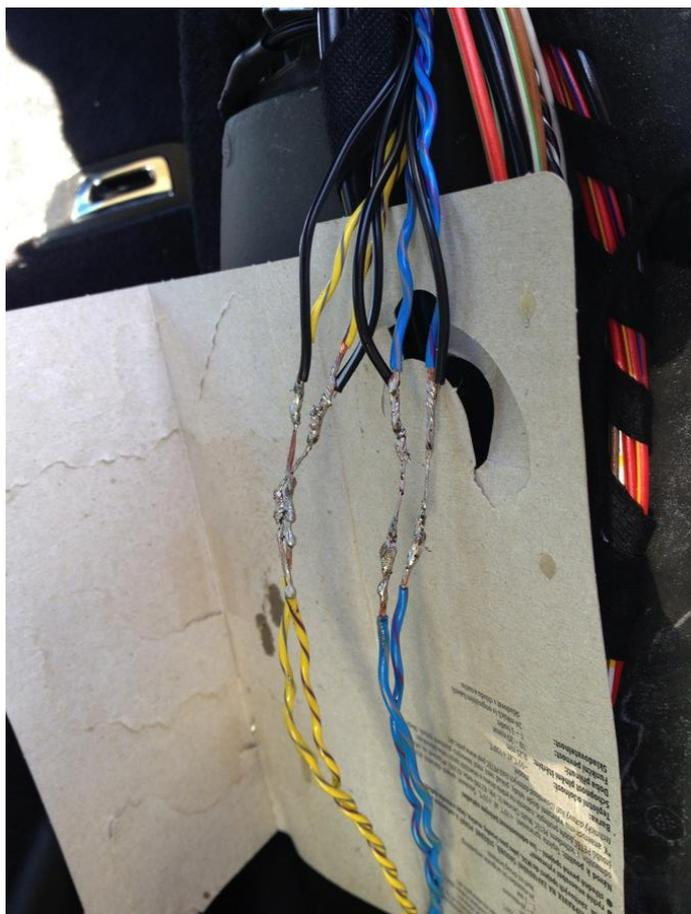
Das Lötresultat bietet sicherlich Verbesserungspotenzial aber es geht recht eng zu, da die Kabel am Einstieg gerade nach unten laufen und somit kaum Platz ist zum anheben. Deshalb habe ich mit den Adern des Cinchkabels die Länge etwas überbrückt. Eine zweite Person erleichtert das Löten hier sicherlich.
